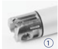
1 Metall Gabelkopf Montageschlitz 6 mm Querbohrung Ø 10 mm
