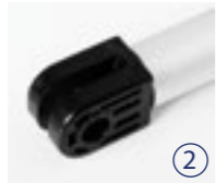
2 Kunststoff Gabelkopf Montageschlitz 6 mm Querbohrung Ø 10 mm
