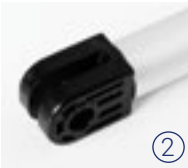
Kunststoff Gabelkopf Montageschlitz 6 mm Querbohrung Ø 10 mm
