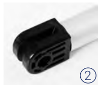
Kunststoff Gabelkopf Montageschlitz 6 mm Querbohrung Ø 10 mm
