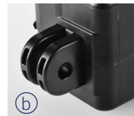
Kunststoff Gabelkopf 90° gedreht Montageschlitz 6 mm Querbohrung Ø 10 mm
